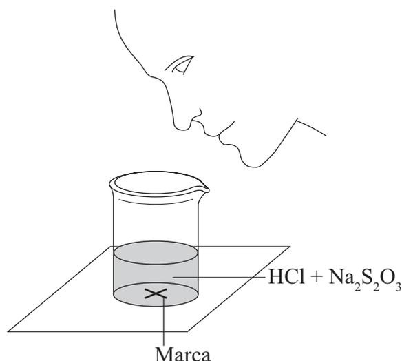
Inicialmente, midieron  $10,0\text{cm}^3$  de solución de ácido clorhídrico  $0,500\text{mol dm}^{-3}$  y luego añadieron  $40,0\text{cm}^3$  de tiosulfato de sodio acuoso  $0,0200\text{mol dm}^{-3}$ . La marca del papel se ocultó 47 segundos después de haber mezclado las soluciones.
